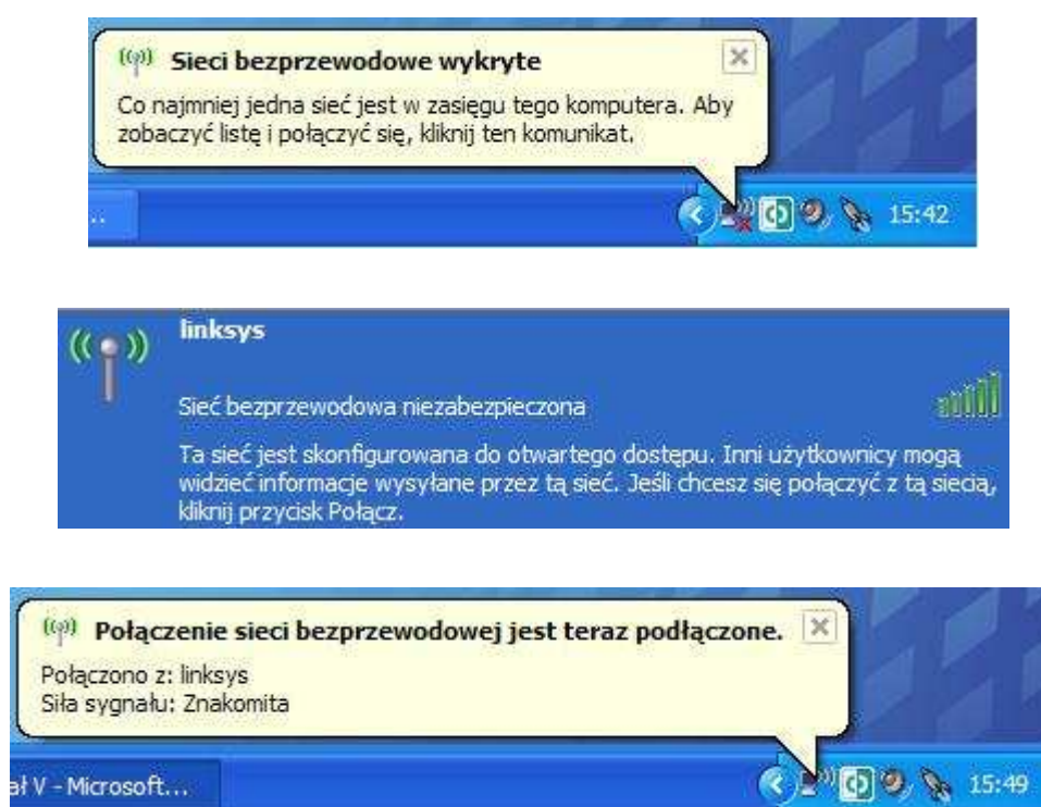
Rys. 10. Kolejne etapy łączenia się z niezabezpieczoną siecią.
