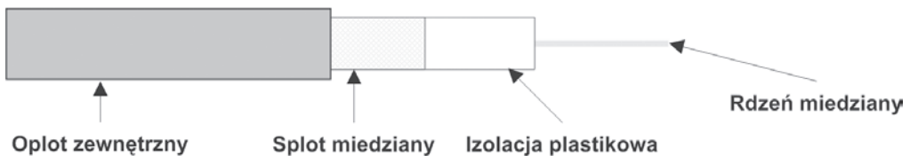
Rysunek 3.1. Budowa kabla koncentrycznego
