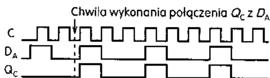
Rys. 13.3. Przebiegi czasowe w rejestrze szeregowym z rys. 13.1 przy połączeniu wyjścia Q_C z wejściem D_A
