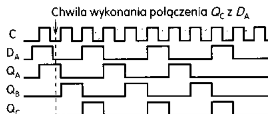
Rys. 13.5. Przebiegi czasowe w rejestrze z rys. 13.1 pracującym jako rejestr szeregowo-równoległy, przy połączeniu wyjścia Q_C z wejściem D_A
