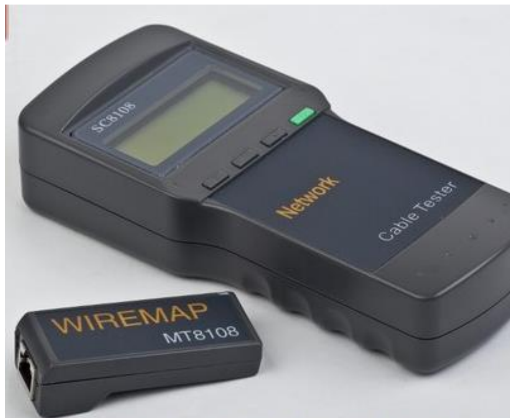
Tester LCD połączeń kabli logicznych i telefonicznych, okablowanie kategorii 5e, 6e, koncentryczne i telefoniczne. Mierzy długość kabla i określa odległość do obwodu otwartego
