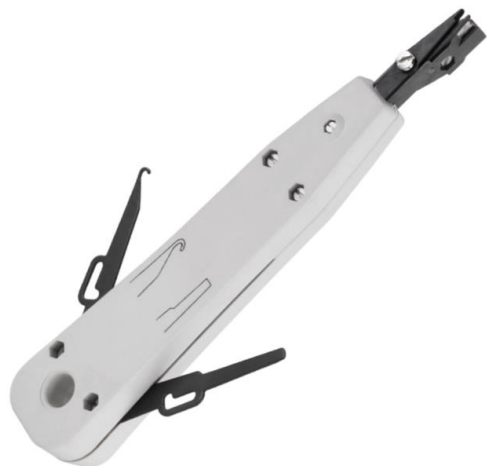
Zaciskacz złącz w puszkach LSA (KRONE) Obcinak kabla 0.5mm. Urządzenie do zaciskania przewodów LAN UTP/FTP w puszkach m.in. do RJ45. Urządzenie po zaciśnięciu przewodu automatycznie przycina końcówkę.
