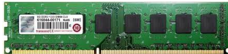
Moduł pamięci DDR3 SDRAM (1,5V, 240 pin)
