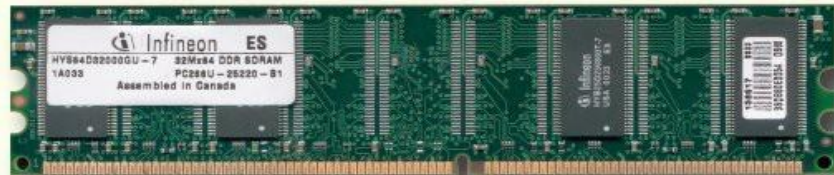
Moduł pamięci DDR SDRAM (2,5V, 184 pin)
