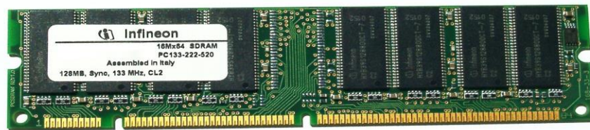
Moduł pamięci SDR SDRAM (3,3V, 168 pin)
