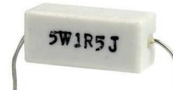
Rezystor 1,5 \Omega 5W. Tolerancja 5%
