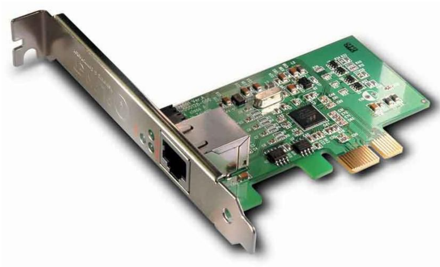
Karta sieciowa złącza PCI- E złącze Ethernet RJ45 P8C8
