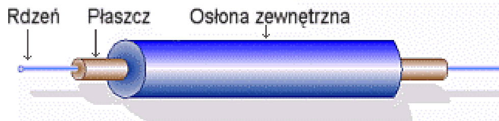
Budowa światłowodu jednomodowego
