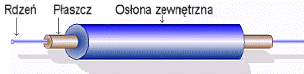
Budowa światłowodu jednomodowego
