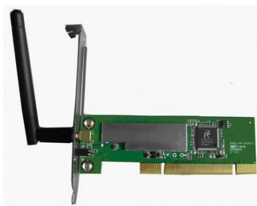
Rys. 4. Przykład karty rozszerzeń w standardzie PCI (karta wi-fi).
