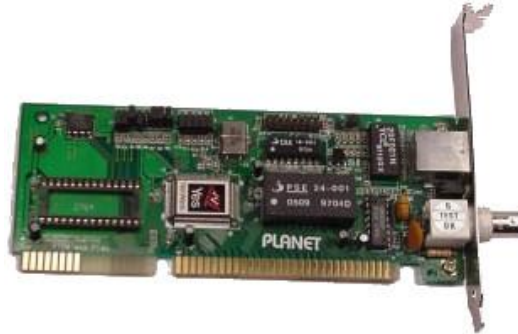
Rys. 2. Przykład karty rozszerzeń (karta sieciowa) do gniazda ISA.
