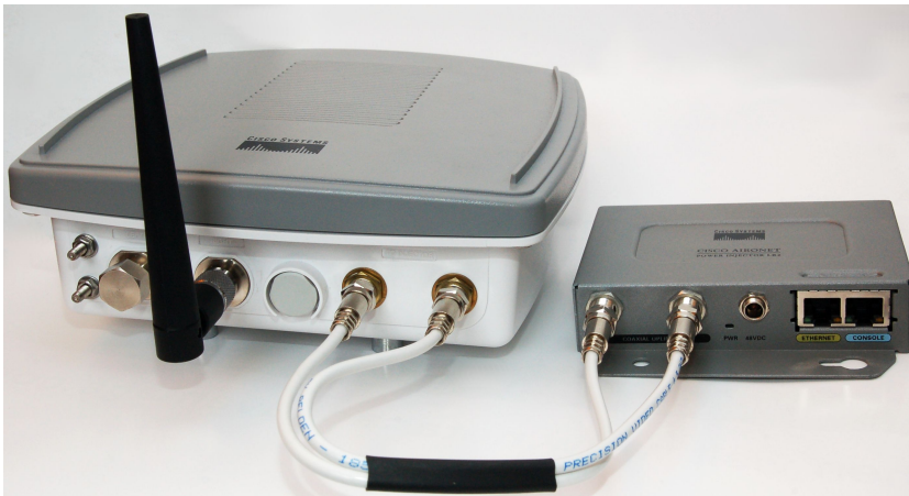
Rysunek 8.6. Punkt dostępowy/most bezprzewodowy, przeznaczony do instalacji na zewnątrz (Aironet serii 1300 [34])
