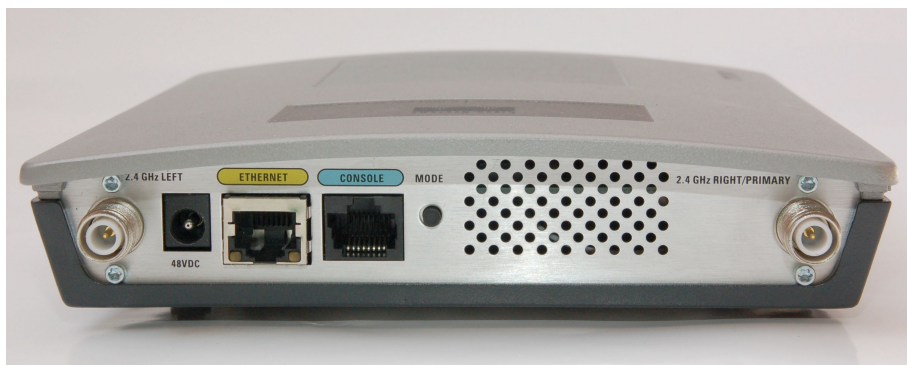
Rysunek 5.2. Bezprzewodowy punkt dostępowy z widocznymi gniazdami przyłączeniowymi
