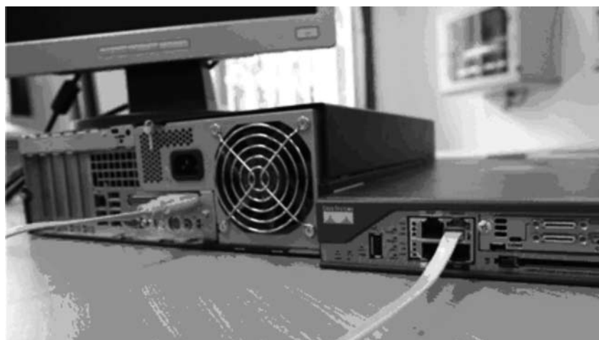
Rysunek 7. Przykład połączenia komputera (terminala) do portu konsuli routera
