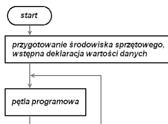
Rys. 1.4.1. Etapy wykonywania programu: przygotowanie środowiska i praca w pętli.
