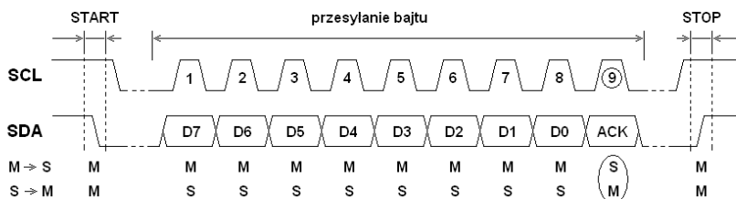
Rys. 1.3.16. Schemat przebiegu transmisji na łączu I 2 C.
