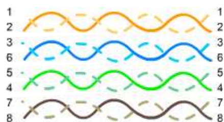
Poprawne podłączenie (standard T568B)
