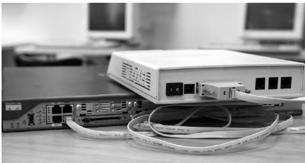
Rysunek 9. Przykład połączenia modemu do pomocniczego portu konsoli routera
