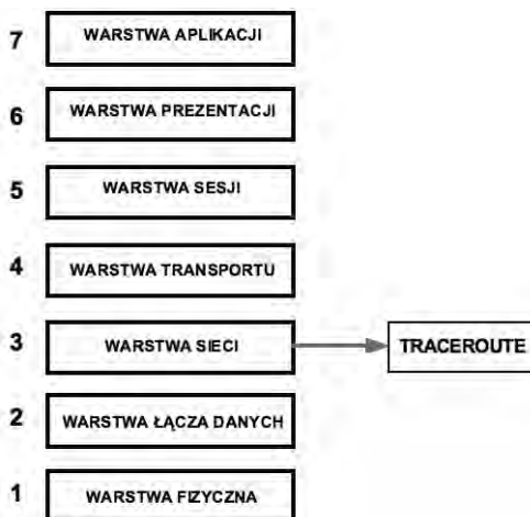
Rysunek 46. Odzworowanie protokołu traceroute na tle modelu odniesienia ISO/OSI
