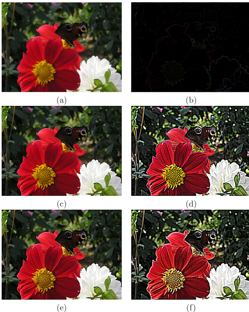
Rysunek 5.11. (a) Przykładowy obraz, (b) maska wyodręszczająca dla parametrów filtru Gaussa: r = 7, \sigma = 4.0 , (c) obraz wyostrzony ze współczynnikiem wzmocnienia \alpha = 1 , (d) obraz wyostrzony ze współczynnikiem wzmocnienia \alpha = 7 - wyraźnie widoczny efekt podbicia lokalnego kontrastu na krawędziach i silne wzmocnienie szumu, (e) obraz wyostrzony z identycznymi parametrami jak w (c) ale wyostrzaniu podlegał jedynie kanał luminacji modelu CIE L^*a^*b^* , (f) obraz wyostrzony z identycznymi parametrami jak w (d) ale wyostrzaniu podlegał jedynie kanał luminacji modelu CIE L^*a^*b^* .
