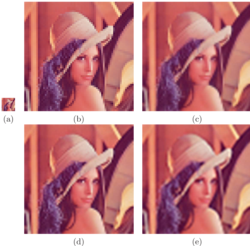
Rysunek 3.4. Interpolacja obrazu przy 8-krotnym powiększeniu: (a) obraz oryginalny w rozmiarze 64 \times 64 oraz obrazy powiększone do rozmiaru 512 \times 512 z zastosowaniem interpolacji: (b) najbliższym sąsiadem, (c) biliniowej, (d) kubicznej, (e) b-sklejanej.
