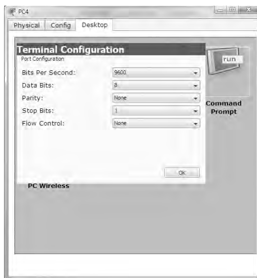
Rysunek 66. Konfiguracja terminala do połączenia z portem konsolowym
