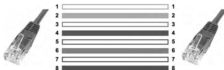
Rysunek 42. Przykład zaterminowania kabla prostego według normy EIA/TIA 568B
