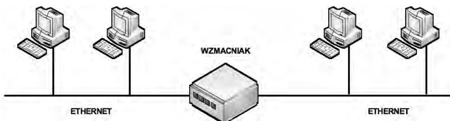
Rysunek 14. Przykład zastosowania wzmacniaka
