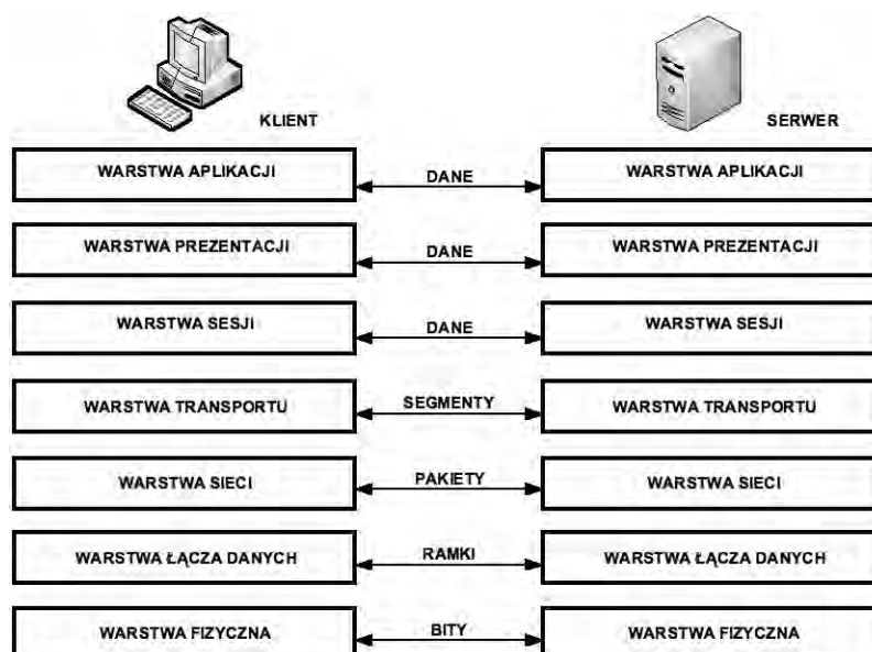
Rysunek 11. Jednostki informacji w poszczególnych warstwach w modelu odniesienia ISO/OSI
