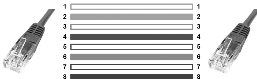
Rysunek 5. Kabel skrętkowy – prosty
